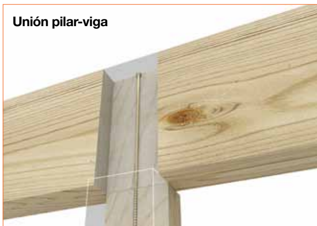
Unión de elementos de armazones de madera en el sector de la construcción de viviendas con armazón de madera (MOB)
